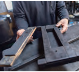
墨玉を入れる型枠
