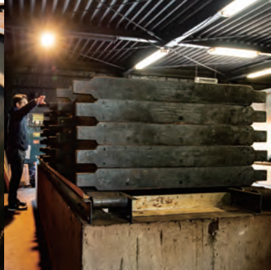
一人でも扱えるサイズの蒸籠。スライド式で作業効率を上げる工夫を。
